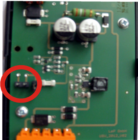
Abbildung 3: Links: Stiftleiste am Print für Akkustecker;
